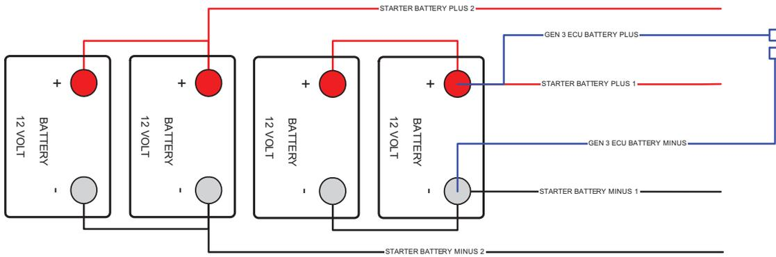
**TWO BATTERY BANKS - TWO BATTERIES PER BANK - DUAL JUMPERS TO STARTER**
